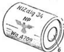
Рис. 12. Детонирующее устройство «Кл. Zdlg. 34NP»: б — отверстие над капсюлем-детонатором, прикрытое бу- мажной прокладкой
