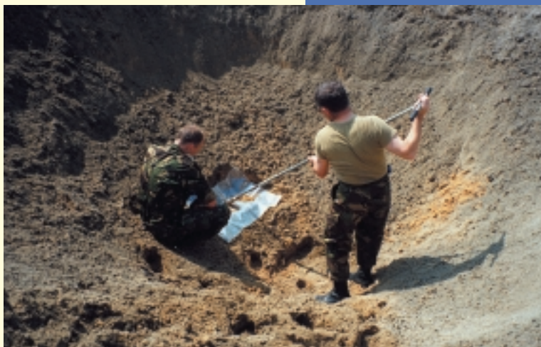
Figuur 2. Onderzoek van een springput waarin oude munitie tot ontploffing is gebracht
