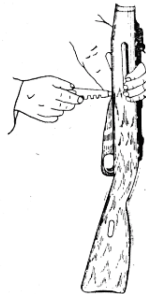
Rys. 187. Wykręcanie przedniego wkrętu głównego
